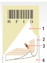
2.attēls. RFID taga uzbūve (Sweeney 2005)
